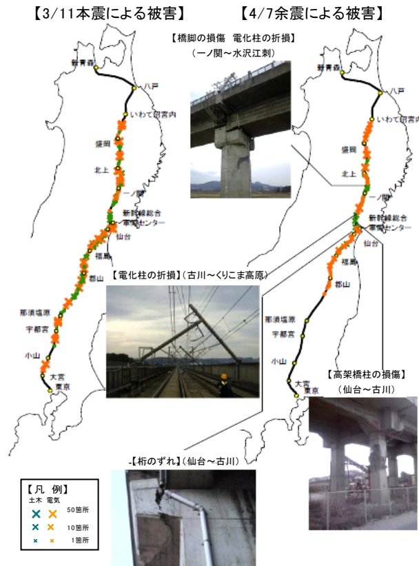
図-1 東北新幹線の地上施設の主な被害と復旧状況(4月17日現在) 東日本旅客鉄道株式会社ホームページより
