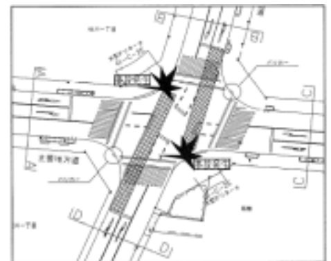
図-2 事故発生地点と交通安全施設
