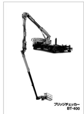
写真-3 T社製橋梁点検車
