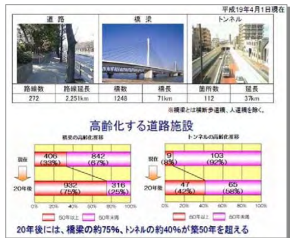
図-3 高齢化する道路構造物
